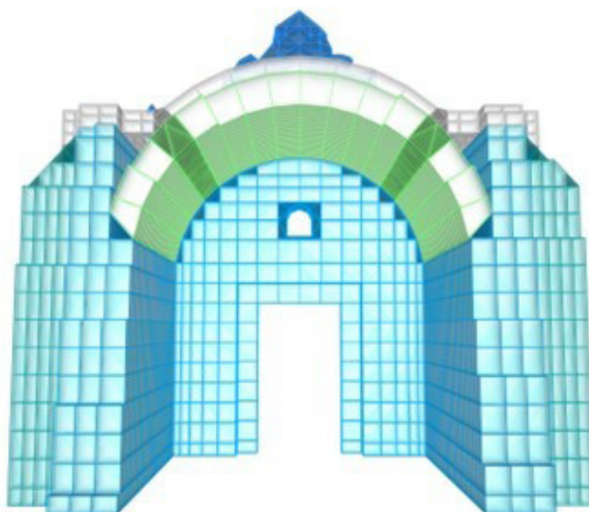
Figura 5.6. Cortes transversales del templo virreinal del siglo XVI construido a base de mampostería irregular y con elementos integrados de concreto, en modelo con elementos sólidos. Fuente: Torres C. (2023)
