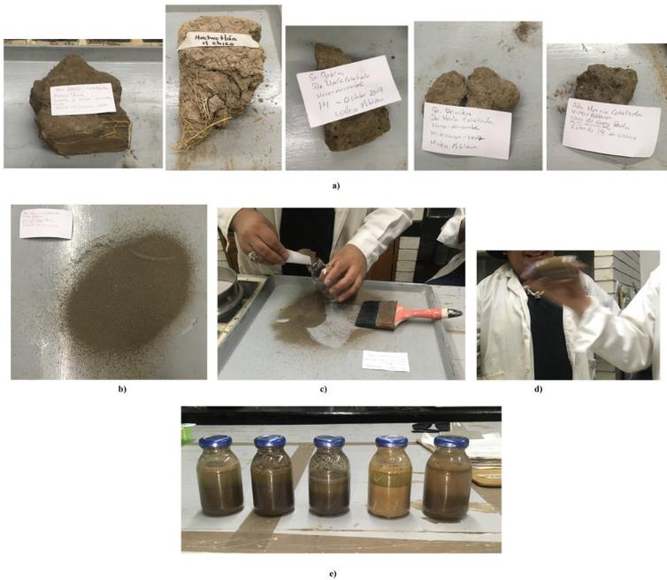
Figura 31. Análisis de los componentes de diversos adobes de la región de la Mixteca Poblana. a) muestras de adobes de viviendas dañadas, b) primer paso: trituration de los adobes, c) paso dos: colocar el polvo en un frasco con agua, d) paso tres: agitar por un minuto e) paso cuatro: reposar para observar las proporciones de arena, limo y arcilla que compone cada muestra [fotos *Proyecto Geografía histórica de la Mixteca Baja*, ENAH, mayo del 2019].
