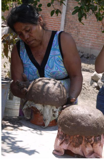
Figura 136. Moldeado de los apaxtles con la base de algún objeto semiredondo, se coloca un trapo húmedo para que no quede directo al molde [acervo *Proyecto Geografía histórica de la Mixteca Baja*, abril 2018].
