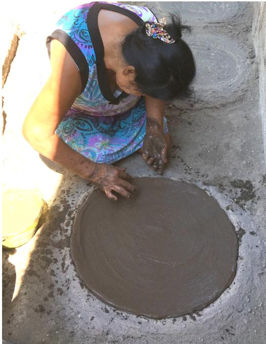
Figura 125. Tendido de la masa en los moldes para formar el comal
