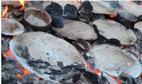
Figura 132. Proceso de encendido y quemado de los comales en el horno abierto hasta consumirse el combustible que lo proporciona la majada, madrugada 5:30 am [acervo Proyecto *Geografía histórica de la Mixteca Baja*, abril 2018].
